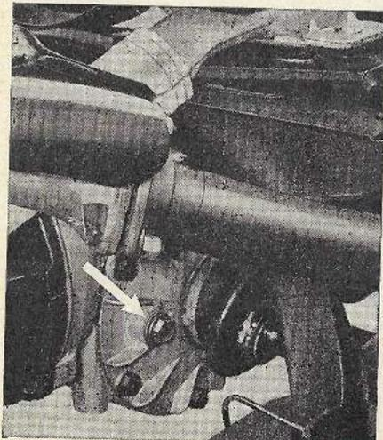
Abb. 40: Getriebeöl-Einfüll- und Kontrollverschraubung
