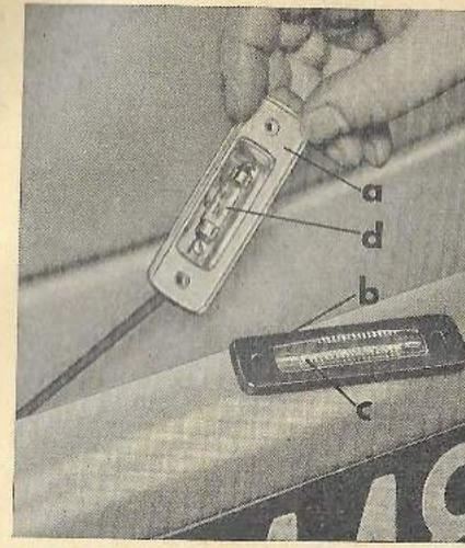
Abb. 55: Einbau der Kennzeichenleuchte 1/56/180
