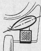
Zweifaden- u. Schlußlichtlampe eingeschaltet
