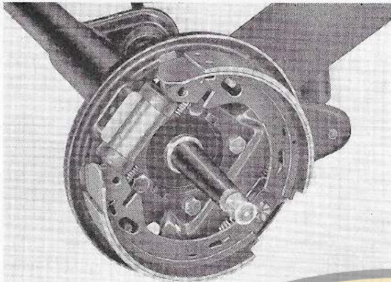
B 12 Bremsstrommel abgezogen
