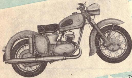
ADLER-FAVORIT, das rassige Motorrad für jeden Zweck, Zweizylinder-Zweitakt, 250 ccm, 16 PS bei 5600 U/min, großer Ansaugeräuschkämpfer, äußerst elastischer und ruhiger Motorlauf, 4 Gänge, Vollschwingen-Fahrwerk mit verstellbarer Hinterrad-Schwinge, 16"-Räder, Höchstgeschwindigkeit ca. 116 km/h.
