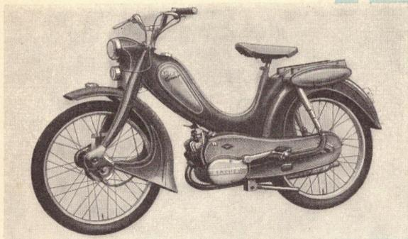
ADLER-EXPORT, das zuverlässige Moped für Beruf und Erholung, millionenfach bewährter SACHS-Einzylinder-Zweitaktmotor, 47 ccm, 1,25 PS, 2- oder 3-Gang-Getriebe, Vollschrwingen-Fahrwerk, Tankrahmen mit großem Durchstieg, Tankinhalt 5 Liter.
