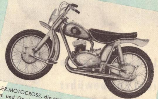
ADLER-MOTOCROSS, die serienmäßige Spezialmaschine für Motocross und Grasbahn, Zweizylinder-Zweitakt, 250 ccm, 20 PS, 4 Gänge, überragender Abzug, beste Beschleunigung, sehr leichtes Vollschwingen-Fahrwerk mit mittellanger Vorderrad-Schwinge, Gewicht der Maschine 125 kg, Bereifung vorn: 2,75-19, Bereifung hinten: 4,00-19.
