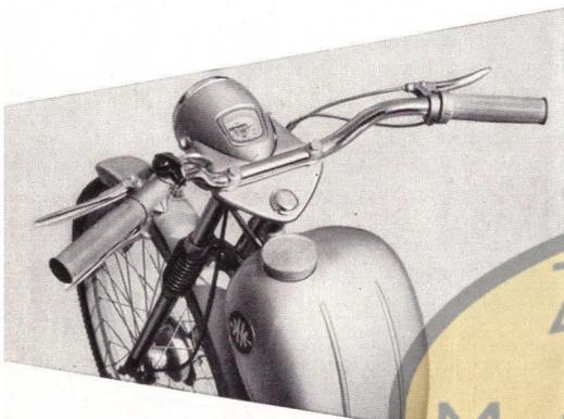
Der elegant geformte Lenker ist verdrehungsfest mit den beiden Hauptholmen der Teleskopgabel verbunden. Die Kopfplatte der Teleskopgabel trägt zugleich wie in einem Armaturenbrett den für Einbautachometer vorgesehenen Scheinwerfer mit 100 mm Lichtaustritt.
