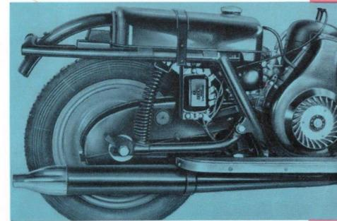
Das ist das Antriebsaggregat der Maicoletta. Alles ist sauber aufgeräumt. Die Kraftübertragung erfolgt durch eine Kette auf das Hinterrad. Die Kette ist vollkommen verkapselt. Staub, Dreck und Wasser können ihr nichts anhaben.
