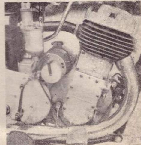
Die Ventilseite des K-Motors. Alle Steuerungsteile sind völlig gekapselt und arbeiten im Ölbad.
