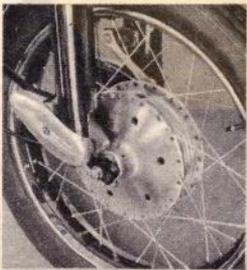
● Mit den neuen Rennbremsen, mit denen die Superlux ausgestattet wurde, taten die NSU-Werke einen entscheidenden Schritt für die Sicherheit. Diese Rennbremsen, die mit 280 qcm Bremsfläche nicht so schnell ihresgleichen finden, wurden direkt von den NSU-Weltmeisterschaftsmaschinen abgeleitet. Hier ist ein Beispiel, wie sie wirken: Der Gesetzgeber verlangt, daß — nur bei
