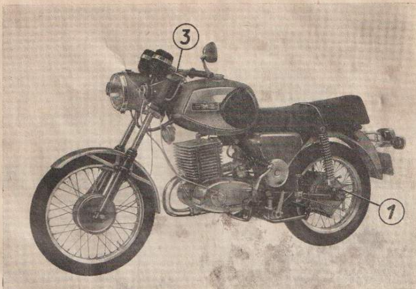
Bild 49. Schmierstellen der TS 250/1 links
