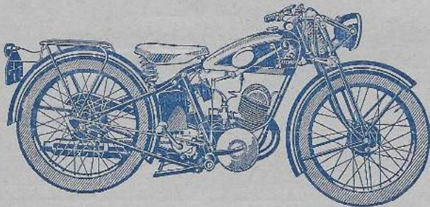
170 ccm Triumph-Zweitaktmotor, abnehmbarer Leichtmetallkopf, Dreiganggetriebe mit Langhebel-Tankschaltung
