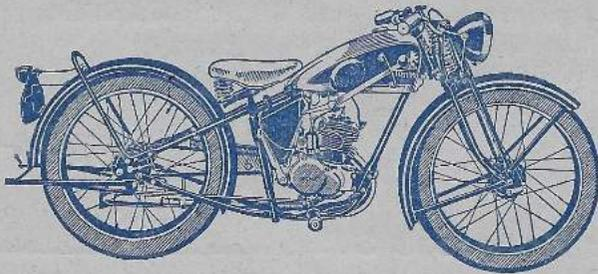
98 ccm Sachs-Motor, Zweigang-Blockgetriebe, leichter Doppel-Rahmen, Chromtank
