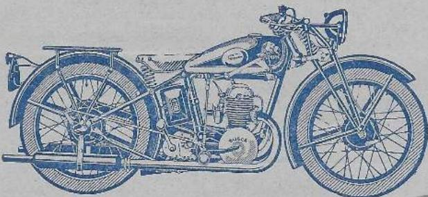
Zweitaktmotor, abnehmbarer Leichtmetallkopf, Doppelauspuff, Dreiganggetriebe, Gemischschmierung
