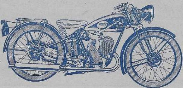
170 ccm Triumph-Zweitaktmotor, abnehmbarer Leichtmetallkopf, Dreiganggetriebe
