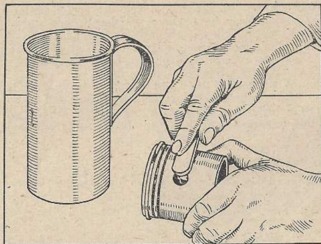
Entfernen von Freßstellen am Kolbenschaft mit einem in Öl getauchten Korundstein
