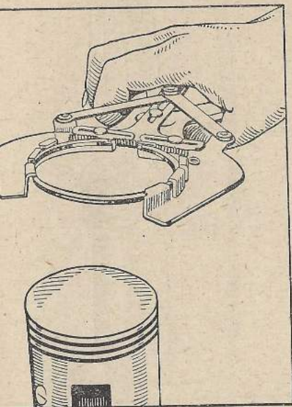
Eine solche Kolbenringzange spannt den Ring ganz gleichmäßig auseinander
