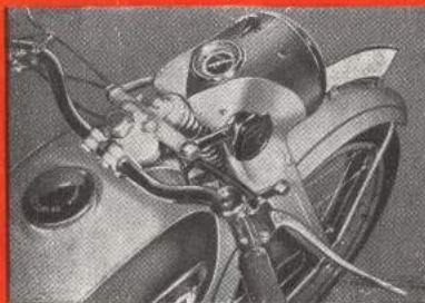
Ein Blick von oben: Großer Tankeinguß, Tachometer im Scheinwerfergehäuse!
