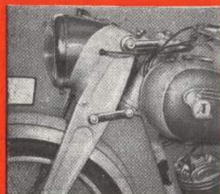
Scheinwerfer, Tacho und Gabel sind zu einer Einheit zusammen- geschmolzen.
